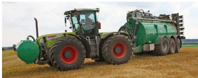
På Claas Xerion'en er By-Pass filtret monteret bag førerhuset.
