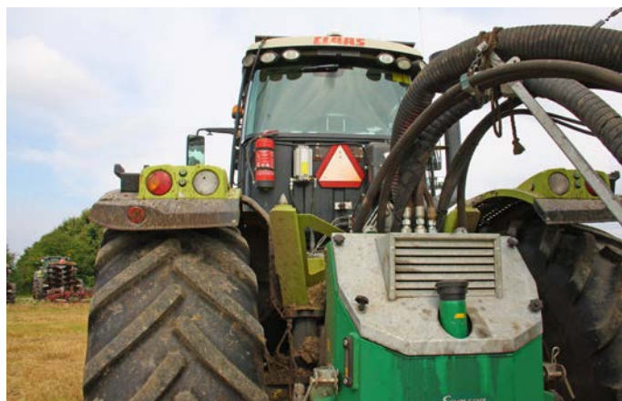
På Claas Xerion'en er By-Pass filtret monteret bag førerhuset.
