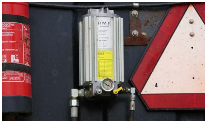
By-Pass systemet er bygget op, så der tages cirka 2-2,5 liter pr. minut ud af systemet. Dette styres af en reguleringsventil i selve enheden. Derefter synker olien langsomt igennem et filtermedie, som er mange gange større end de almindelige filtre.
