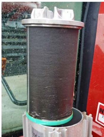
Figur 1 Billedet fra Brørup taler sit tydelige sprog. Det viser, at der bliver fanget mange partikler, som ikke er ønskeligt, at transmissionen skal arbejde i. Uønskede partikler som et traditionelt filter på 10 my ikke ville have opfanget. By-Pass filteret er på 0,5 my, fortæller Lars Emil Bak.
