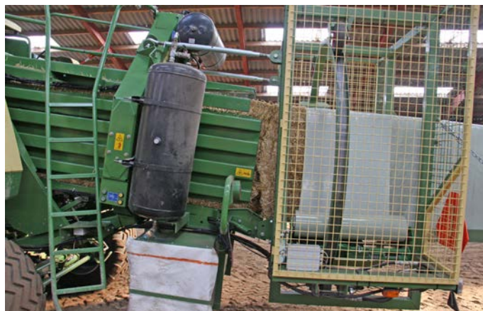
Brandslukningsudstyr påmonteret på de to ballepressere efterspændt de to finsnittere. Der er vand i tankene, da Torben Kamp ikke mener pulverlukning fungerer optimalt. - Vand slukker ilden, og køler samtidigt, siger han.
