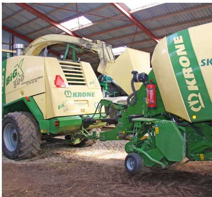
Brandslukningsudstyr påmonteret på de to ballepressere efterspændt de to finsnittere. Der er vand i tankene, da Torben Kamp ikke mener pulverlukning fungerer optimalt. - Vand slukker ilden, og køler samtidigt, siger han.
